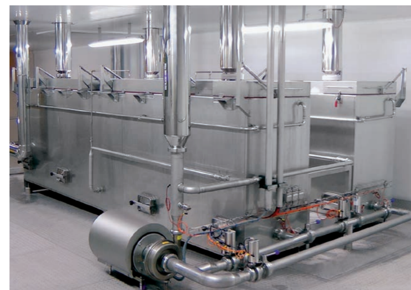
■ Bacs de refroidissement (eau glacée)
