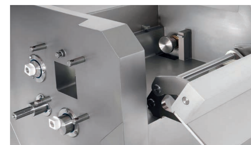
■ Chambre entièrement en inox avec paroi latérale de compression (Cubixx 120)
