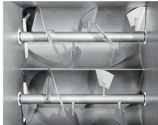
■ Combinaison d'arbres de mélange à palettes et à rubans
