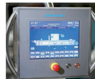
■ Interface de commande sur bras mobile
