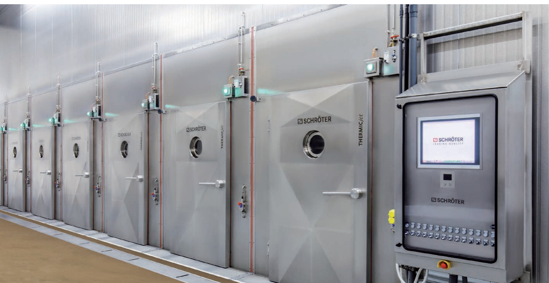
■ Cellules de cuisson humide, cuisson sèche, étuvage, séchage, fumage, rôtissage munies de portes à poignées simples et hublots (option)
