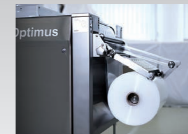
■ Bobine inférieure avec bras tendeur
