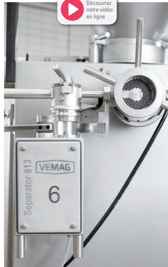
■ Dénerveur continu type 813 plus efficace, aide à la précision du dosage
