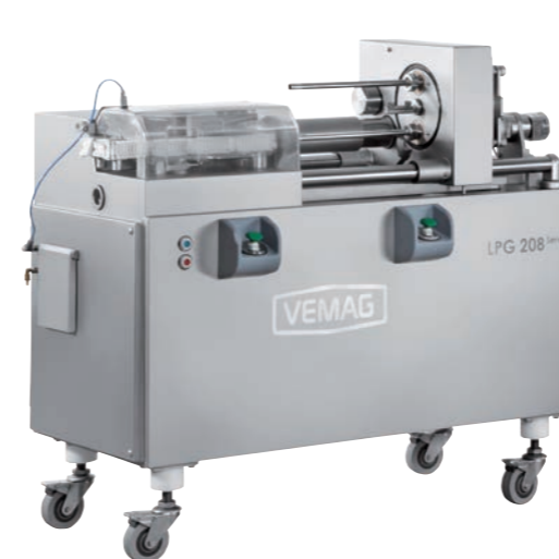
■ Module de calibration et de torsadage LPG 208 avec barillet et mise en place manuelle des boyaux
