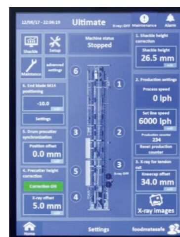
■ L'écran tactile fournit à l'opérateur des mesures précises en temps réel
