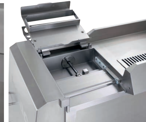
■ Guillotine pneumatique latérale pour les applications fromage
