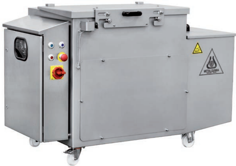
■ Module NEEDLECLEAN: nettoyage automatique des aiguilles
