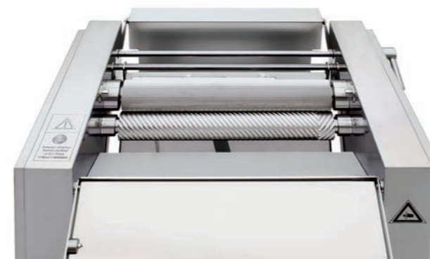
■ Les Références V 4744 et V 5744 turbo dispose d'un support de lame solidaire et basculant
