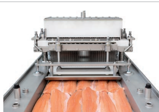
■ Têtes d'injection pour marinades de poissons
