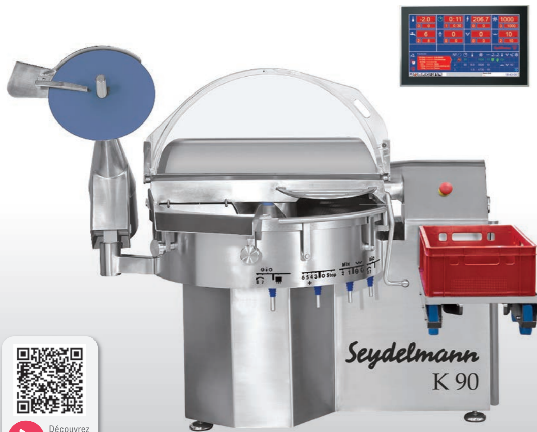
■ Cutter atmosphérique 90 l avec élévateur pour bacs E2 (option)
