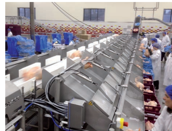
■ Système de triage classique avec tapis d'alimentation, pesage dynamique et tapis de triage
