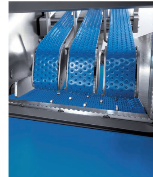
■ Tapis de maintien supérieur: vue côté sortie du produit
