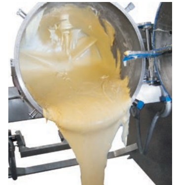
■ Vidage par basculement de la cuve
