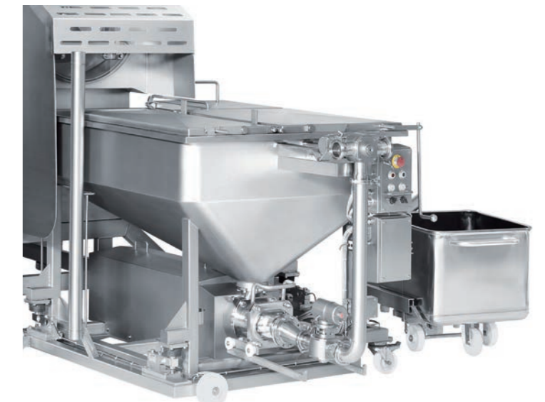
■ Trémie tampon avec pompe (forme et volume selon projet)
