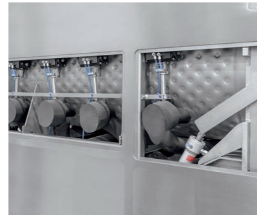
■ Double enveloppe pour un refroidissement et un chauffage indirects efficaces
