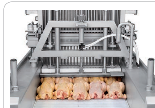
■ Têtes d'injection pour marinades de volailles
