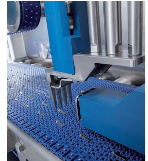
■ Griffe de maintien arrière, avancée continue ou séquentielle
