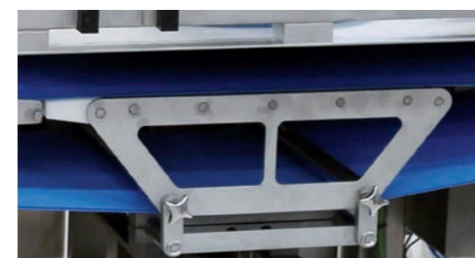
■ Plateau élévateur jusqu'à 80 mm du module kebab
