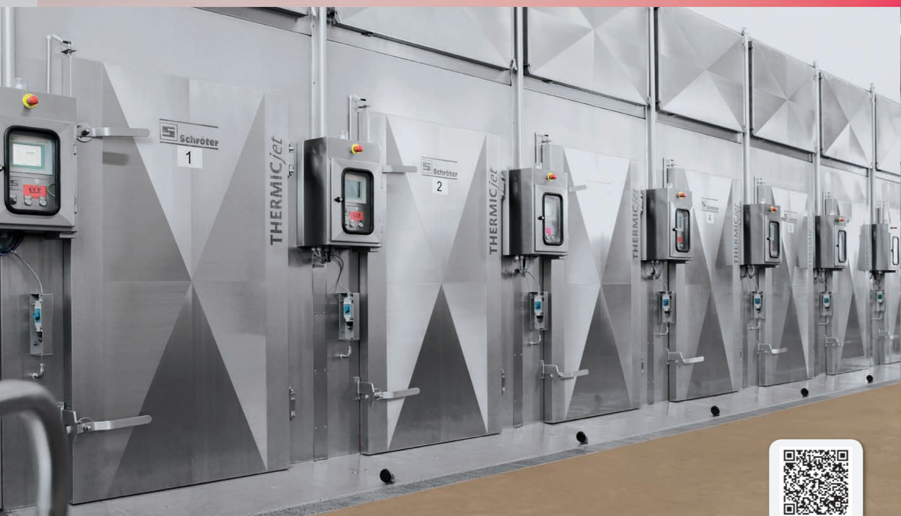
■ Cellules de cuisson humide, cuisson sèche, étuvage, séchage, fumage, rôtissage munies de portes à deux poignées Capacité de 1 à 40 chariots disposés sur 1 ou 2 rangées. Énergie vapeur, électricité ou gaz. En série température réglable de 40 à 95 °C. En option de 20 à 250 °C
