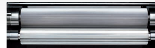
■ Rouleau entraîneur avec stries longitudinales fines
