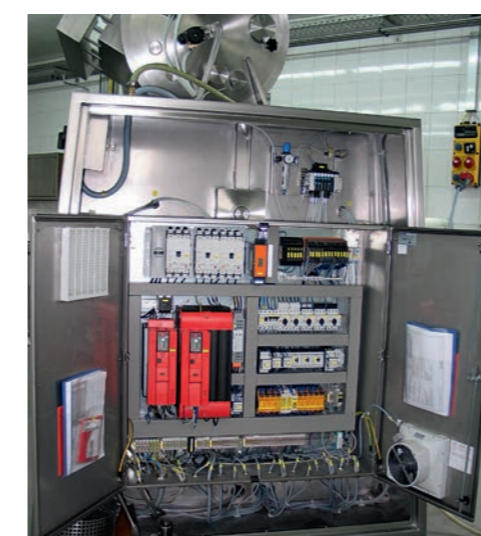
■ Armoire électrique incorporée au carter latéral
