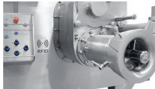
■ Système de reconnaissance des ensembles de découpe RFID pour prévenir les erreurs d'opérateur
