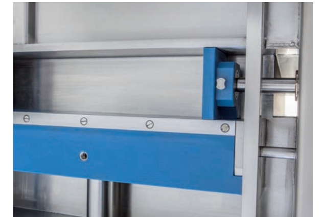
■ Paroi latérale mobile + piston en matière synthétique bleue détectable
