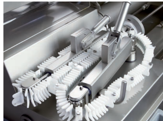
■ Les modules LPG disposent de bandes à longueurs prédéterminées permettant un fonctionnement à haute cadence. Les bandes sont aisément interchangeables
