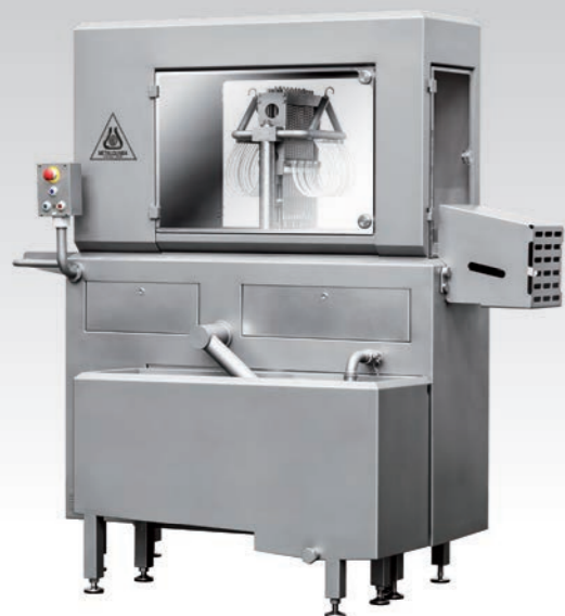
■ Injecteur MOVISTICK 30 PC Pour petites productions, 1 tête, rétractable pour viande avec ou sans os
