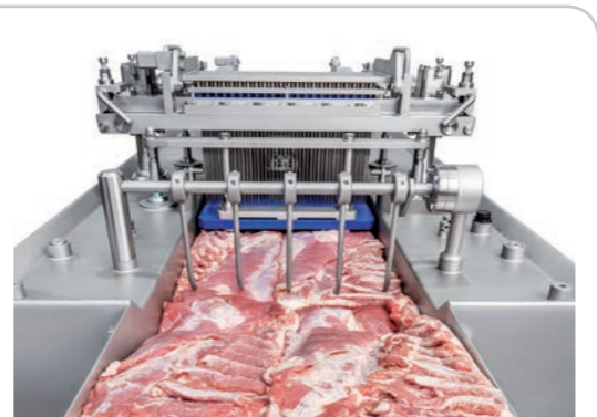
■ Têtes d'injection pour poitrines de porc
