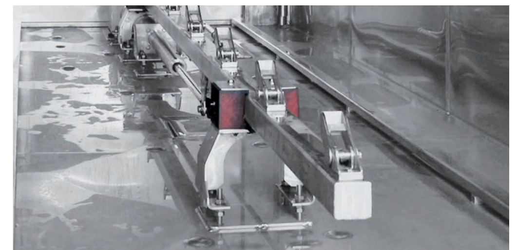
■ Barre à cliquets pneumatique pour chariots sur roues
