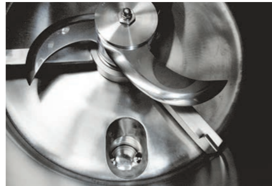
■ AGM: tête à 3 couteaux + racleur et vanne de vidage
