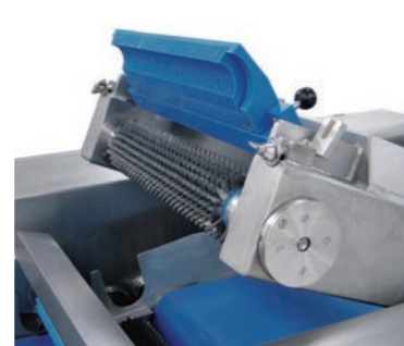
■ Rouleau couteaux (inf et sup) peigne en position de nettoyage
