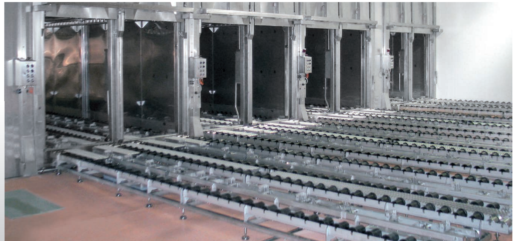
■ Stockage tampon en sortie, sur transrouleurs pour chariots sans roue
