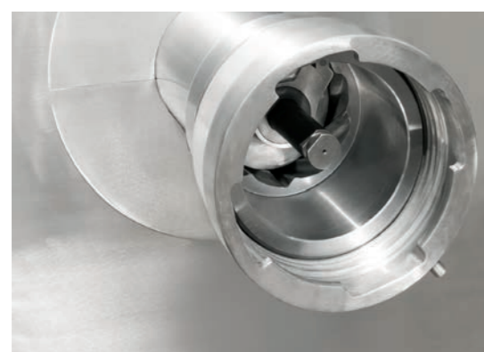
■ Remplacement du bâti de vis (vue extérieure)
