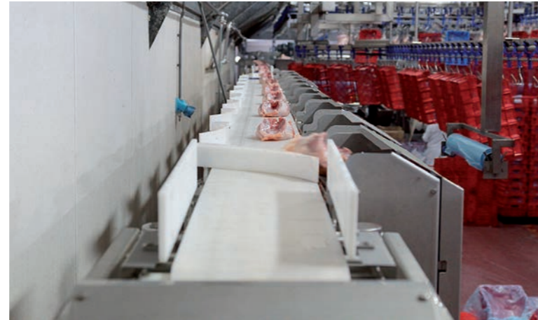
■ Bras de poussée pour une vitesse de tri supérieure
