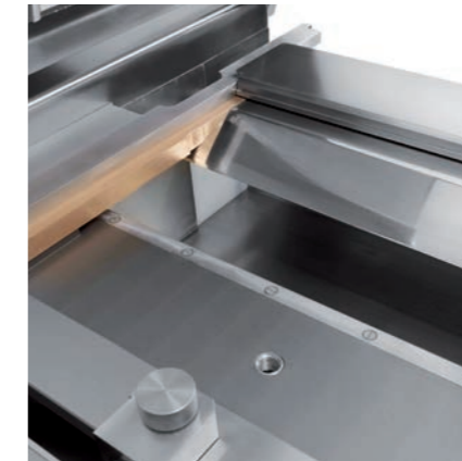
■ Chambre avec paroi latérale mobile en aluminium et guillotine hydraulique latérale
