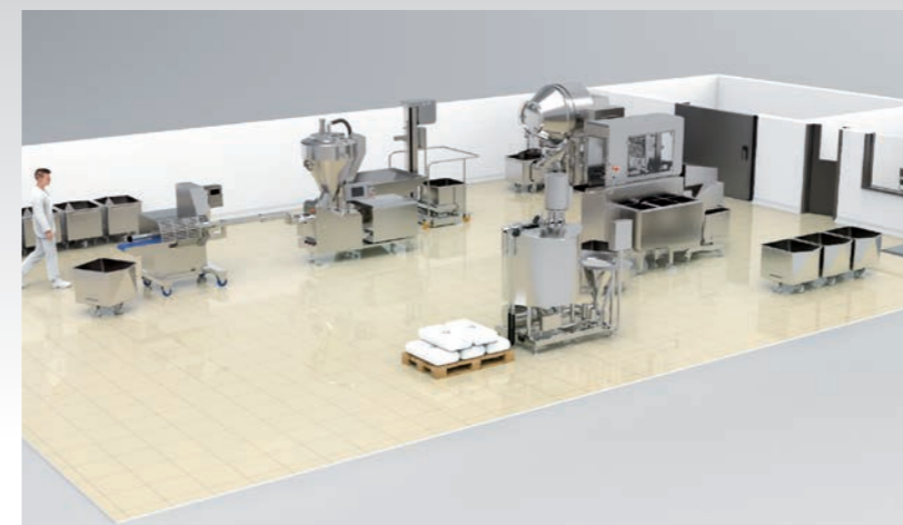
■ Ligne automatique complète PX LINE Configuration et choix des machines prédéfinis pour le salage des viandes cuites. Installation clé en main
