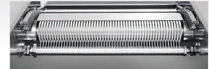
■ Rouleau entraîneur à stries longitudinales et transversales + peigne
