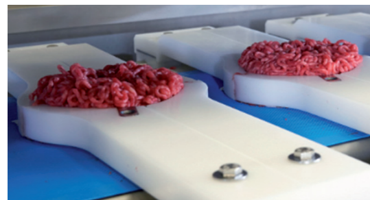
■ 4 bras de formage pour steaks hachés à fibres horizontales
