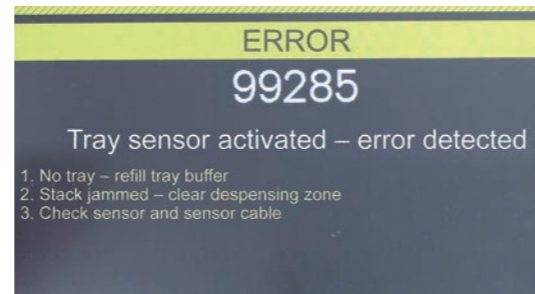
■ Indication d'erreur avec solutions proposées FD 316
