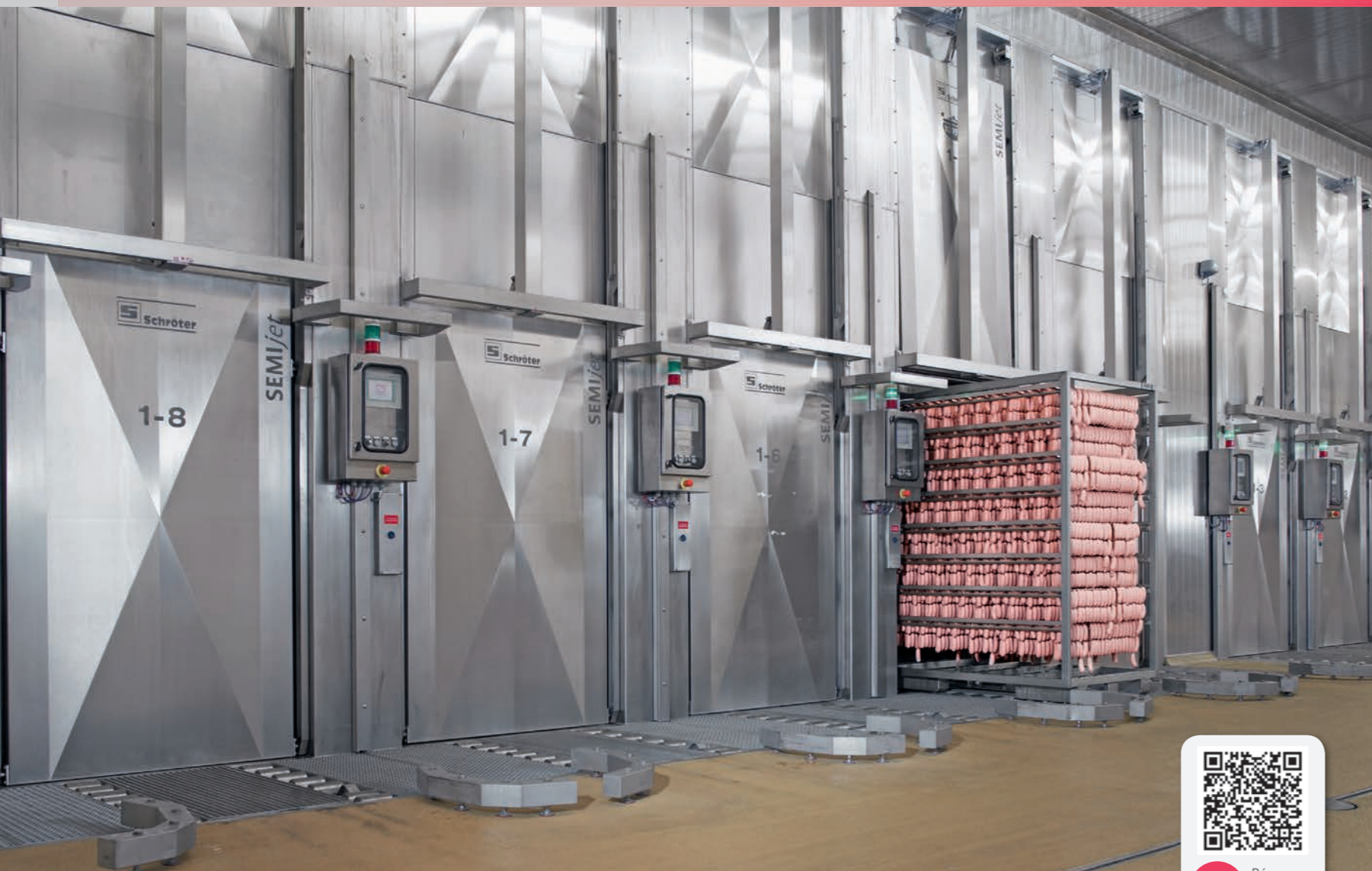
■ Cellule semi-continue - Dépose extérieure intégrée au sol
